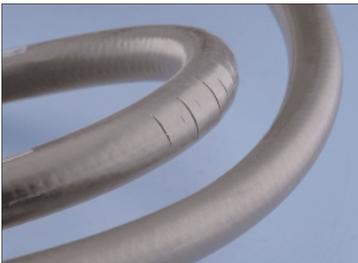
Ook ozon (foto linksonder), olie (foto rechts) en lekken (foto rechtsonder) kunnen slijtage van de slangen veroorzaken
